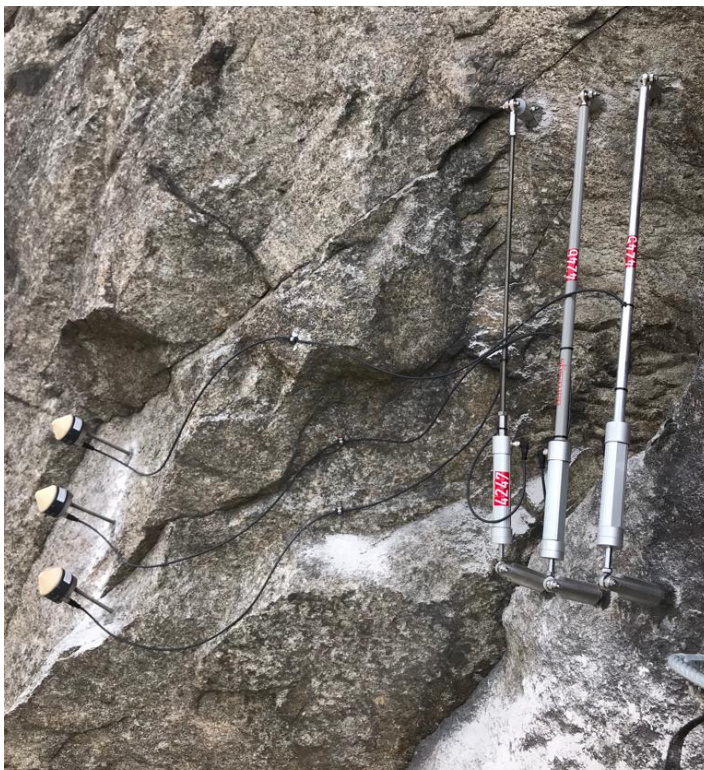
Bild 4: In situ Vergleich dreier Verlängerungsstangen-Materialien im Einsatz eines TJM: (a) Inox, (b) Kohlefaser (AarteLink® CFK) und (c) Aluminium (von links nach rechts).
