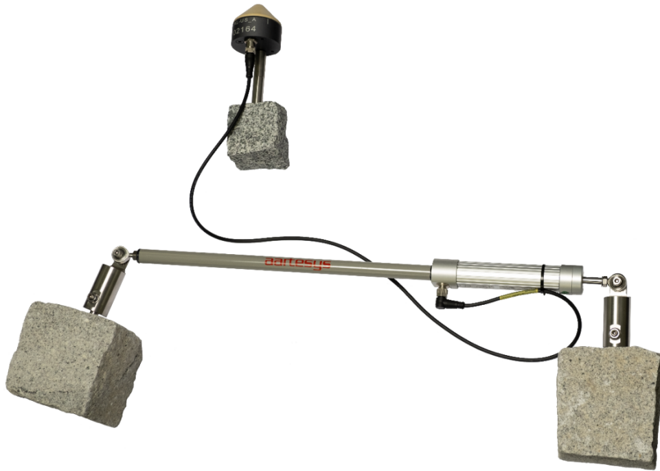
Bild 3: Installation eines AarteLink ® TJM ng. Die AarteLink® CFK-Verlängerung (mit Schriftzug «aartesyS») des Messinstruments kann (a) nach Mass (Bild), (b) mit Teleskoprohr (flexibel) oder (c) mit Standardlängen plus Gewindestange (flexibel) erfolgen. Der AarteLink® Universalsensor kann mehrere Meter abgesetzt werden (typ. 1-2 m, um die Funkverbindung zum AarteLink® Gateway zu optimieren).
